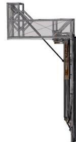
Projekt Hong Kong Land - Landmark Shopping Mall HK. 2x Lautsprecherlift Systeme mit selbstentwickeltem internen Kabelmanagement System. Gewicht des Lautsprechers 90kg, länge 3m.
